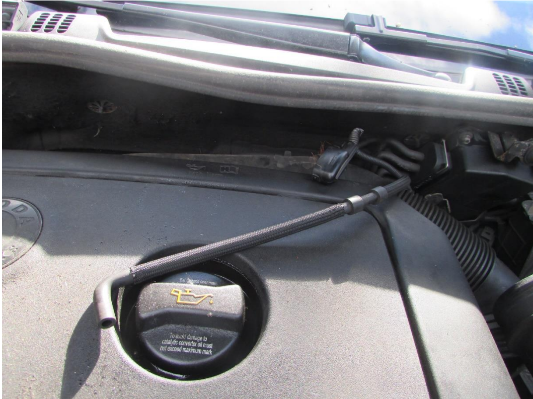
Foto č. 27 (IMG_4326.JPG) Odpojená váha vzduchu
