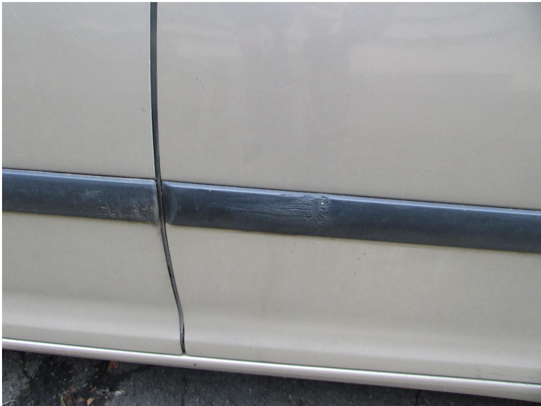
Foto č. 15 (IMG_4314.JPG) Poškozené lišty na levých dveřích
