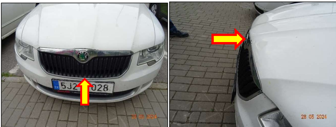
Foto 14,15 pohled na poškození od havárie vozidla na přední části
