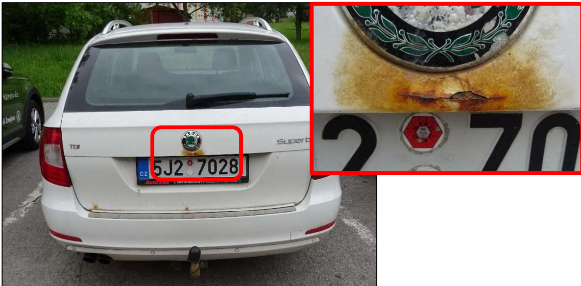
Foto 13 Pohled na 5- té dveře – pokročilá korozí
