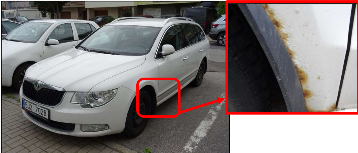
Foto 12 Pohled na korozí vozidla LP blatník
